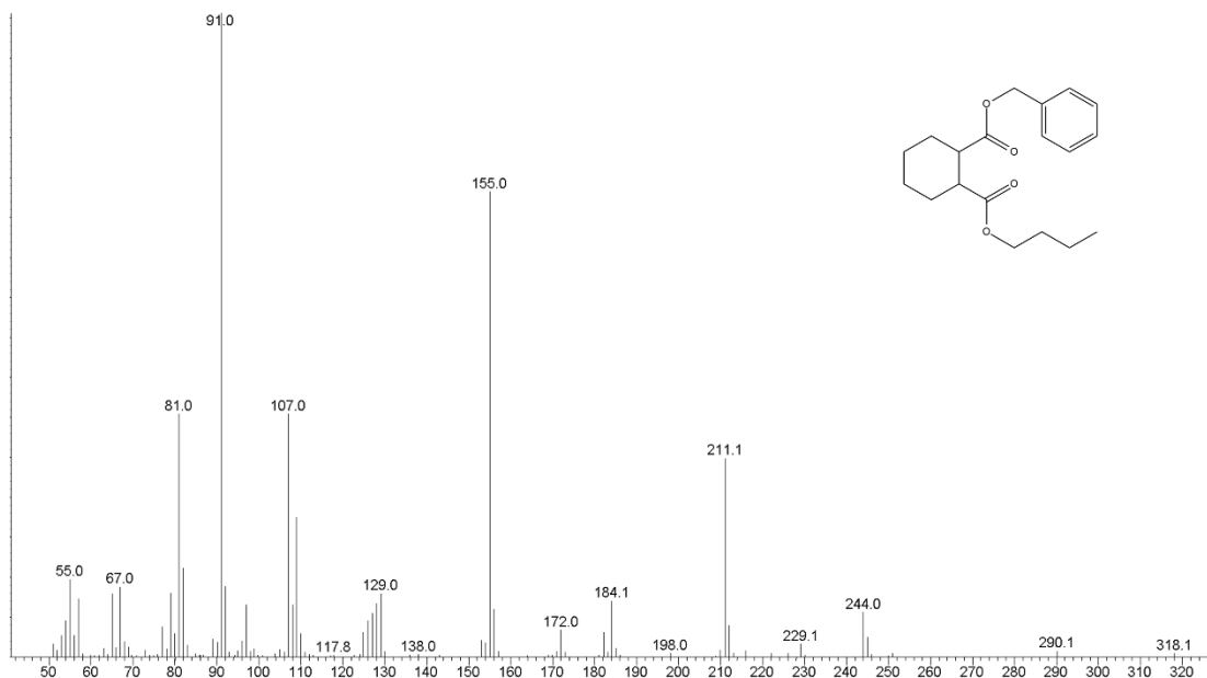
Figure S10: GC-MS spectrum of benzyl butyl 1,2 cyclohexane dicarboxylate ester (MW = 318 g mol -1 ). GC-MS (EI, 70 eV): m/z (rel. int., %): 318 (1), 290 (1), 245 (3), 244 (7), 212 (4), 211 (29), 206 (1), 185 (1), 184 (1), 182 (2), 172 (4), 157 (1), 156 (6), 155 (61), 153 (3), 130 (1), 129 (10), 128 (8), 127 (5), 126 (2), 125 (4), 111 (3), 109 (20), 108 (7), 107 (38), 108 (7), 97 (3), 92 (11), 91 (100), 89 (2), 83 (2), 82 (13), 81 (30), 80 (3), 79 (9), 78 (1), 77 (4), 73 (3), 68 (2), 67 (8), 66 (1), 65 (10), 63 (1), 57 (7), 56 (3), 55 (6), 54 (4), 53 (3), 51 (2).
