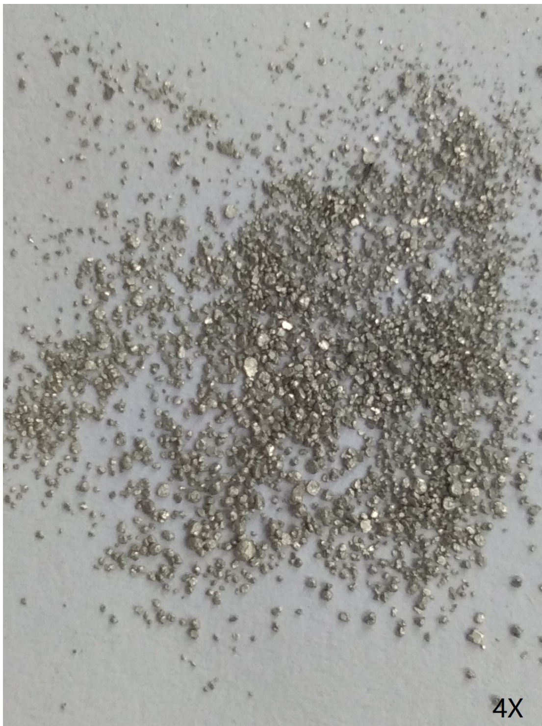
Al powders after ball-milling, (d) in Fig 1.
