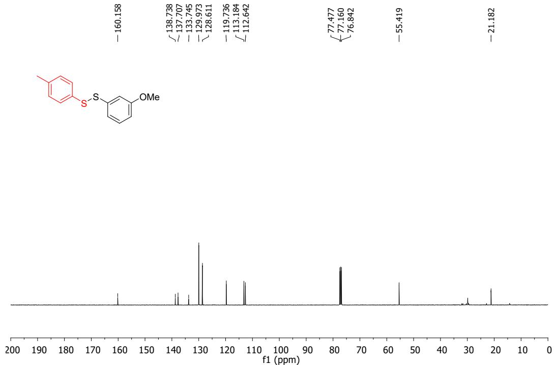
**Fig. S14.**  $^{13}\text{C}$  NMR spectrum of 1-(3-methoxyphenyl)-2-(p-tolyl)disulfane (**2bd**)
