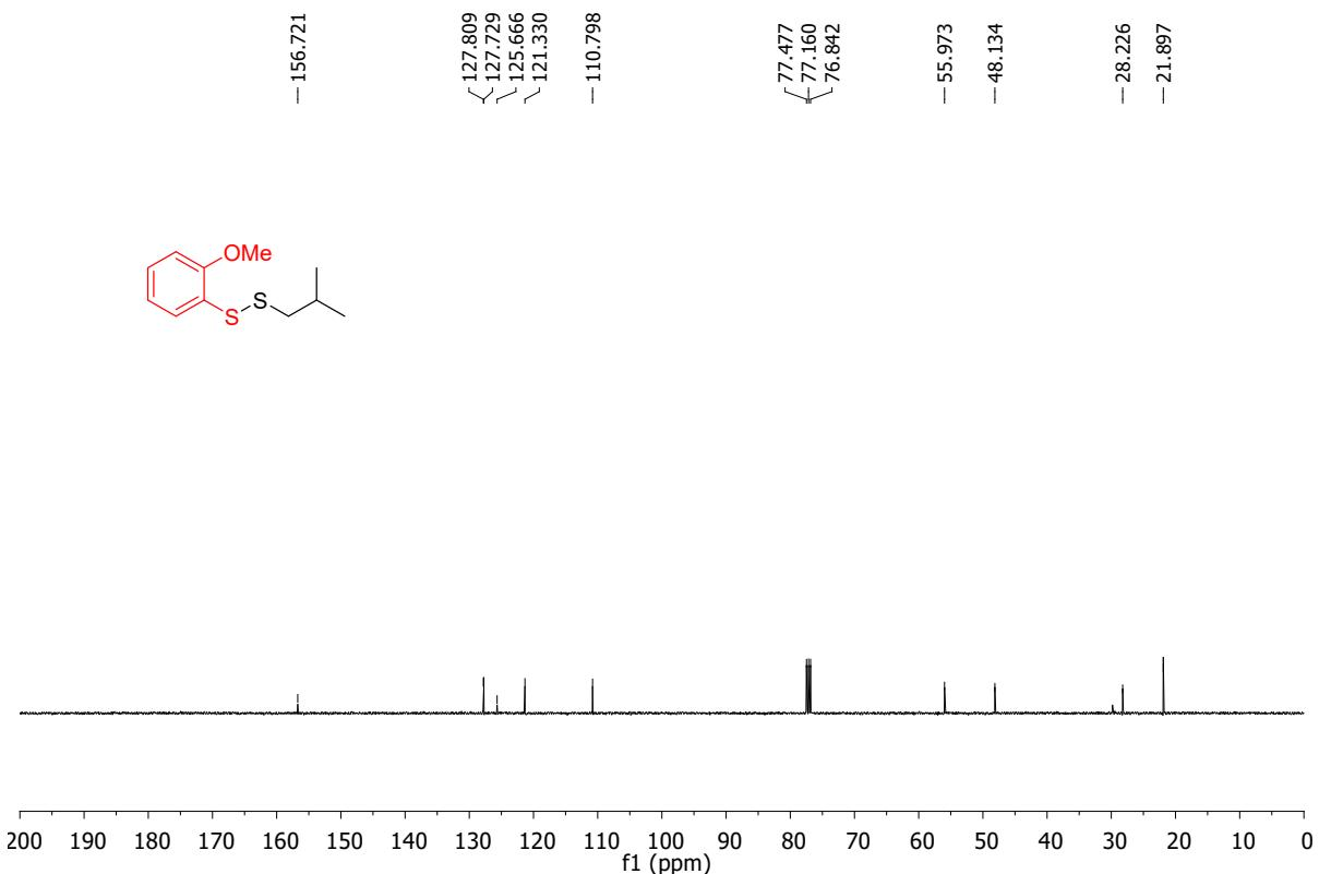
**Fig. S22.** <sup>13</sup>C NMR spectrum of 1-isobutyl-2-(2-methoxyphenyl)disulfane (**2cn**)
