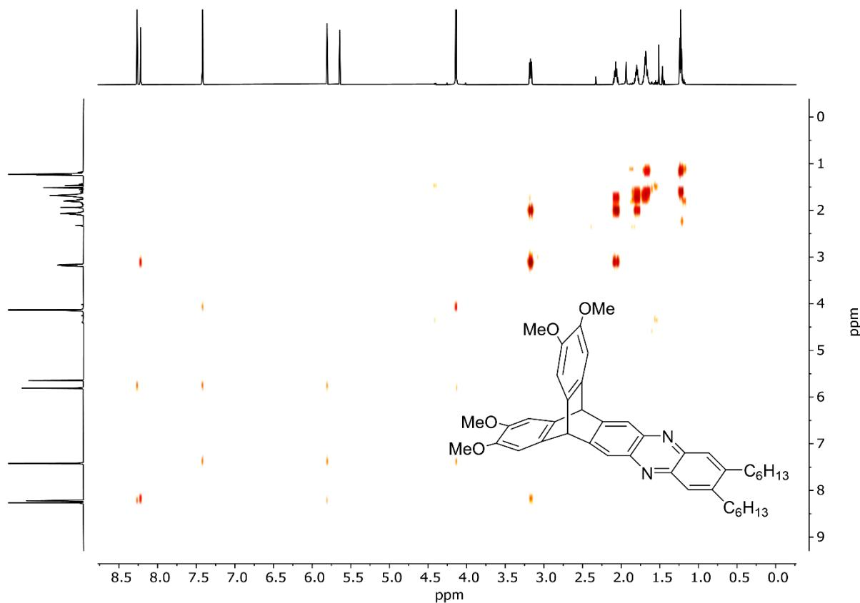
**Figure S16:**  $^1\text{H},^1\text{H}$ -COSY Spectrum ( $\text{CD}_2\text{Cl}_2$ , 600MHz) of **4**.
