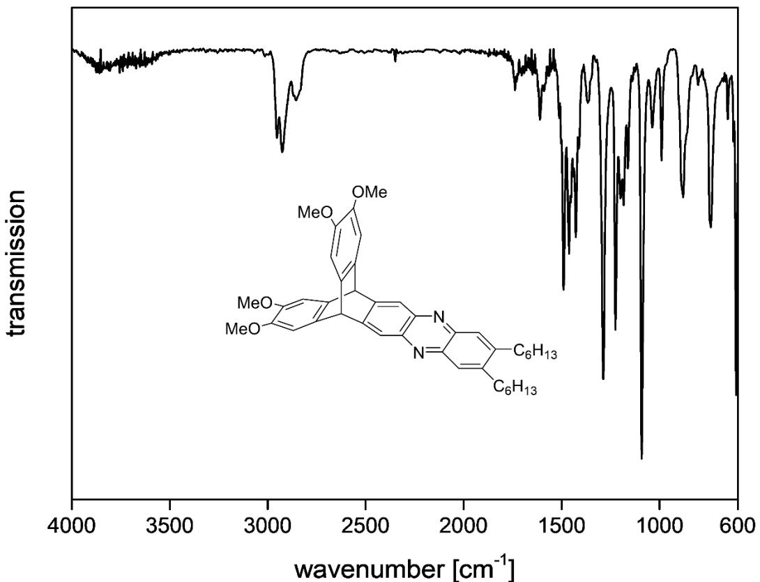
**Figure S50:** IR Spectrum (ATR, ZnSe) of 4.
