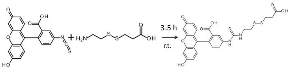
Fig. S2 Synthesis of FITC-S-S-COOH.
