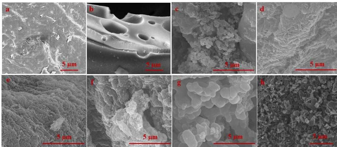
**Fig. S1** Scanning electron microscope (SEM) images of a) Chitosan, b) Lignin, c) CL(10:90), d) CL(25:75), e) CL(50:50), f) CL(75:25), g) CL (90:10), h) Norit
