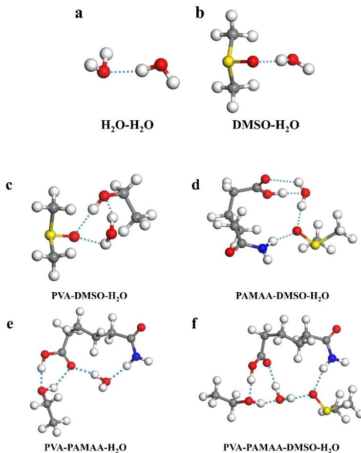
**Figure S1.** DFT analysis and hydrogen bonding interactions of (a)  $\text{H}_2\text{O}-\text{H}_2\text{O}$ , (b)  $\text{DMSO}-\text{H}_2\text{O}$ , (c)  $\text{PVA-DMSO}-\text{H}_2\text{O}$ , (d)  $\text{PAMAA-DMSO}-\text{H}_2\text{O}$ , (e)  $\text{PVA-PAMAA}-\text{H}_2\text{O}$ , (f)  $\text{PVA-PAMAA-DMSO}-\text{H}_2\text{O}$ .
