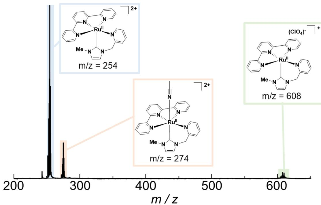
Fig. S5 An ESI-TOF mass spectrum of  $\text{RuC}(\text{ClO}_4)_2$ .
