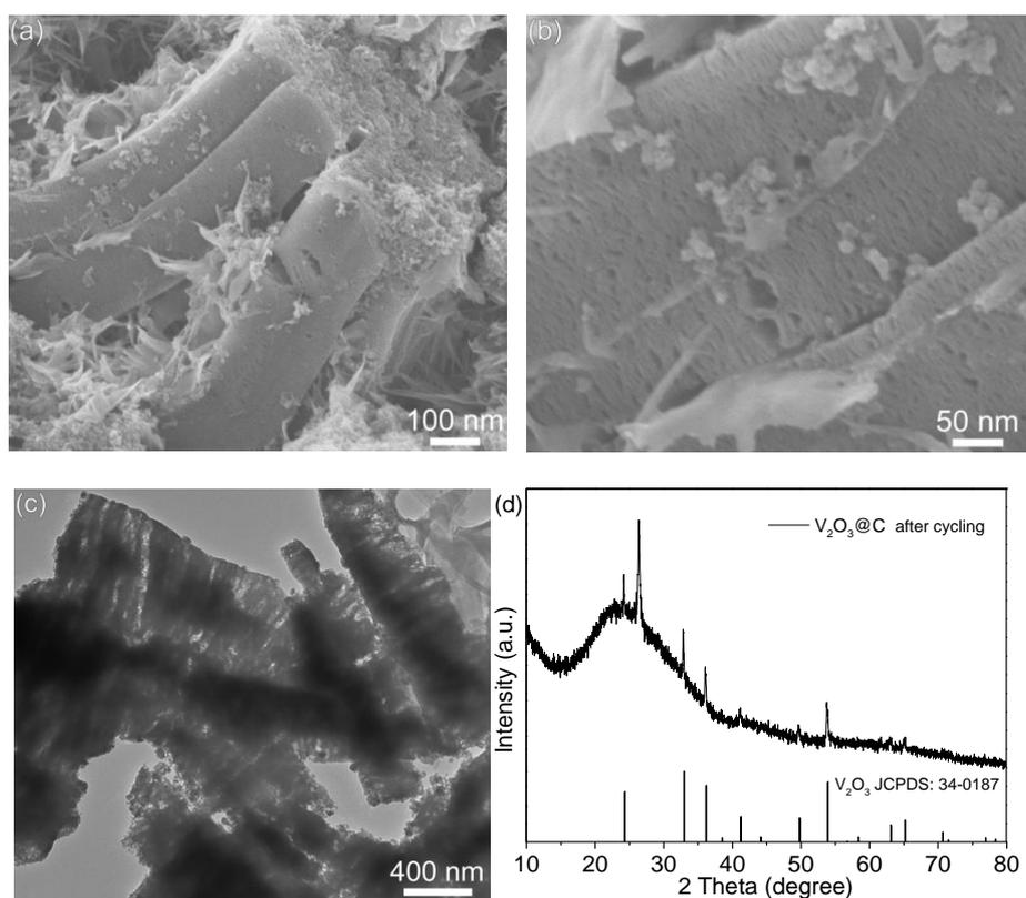
**Fig. S16** (a,b) SEM images, (c) TEM images and (d) XRD pattern of  $V_2O_3@C$  after 100 cycles at  $0.3 \text{ A g}^{-1}$ .
