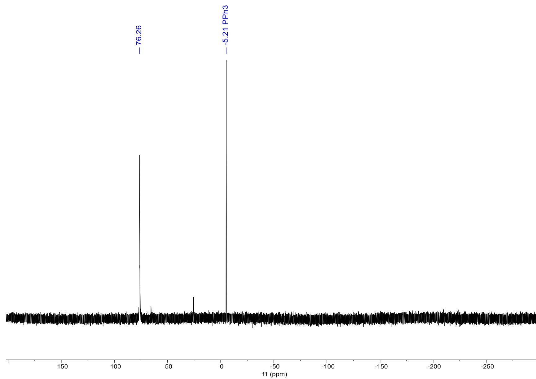
Figure S35:  $^{31}\text{P}$  NMR (202.5 MHz,  $\text{CDCl}_3$ ) spectrum of  $\text{Et}_3\text{PO}$  and  $\text{B}(3\text{-F}_1\text{H}_4\text{C}_6\text{O})_3$  (**2**).
