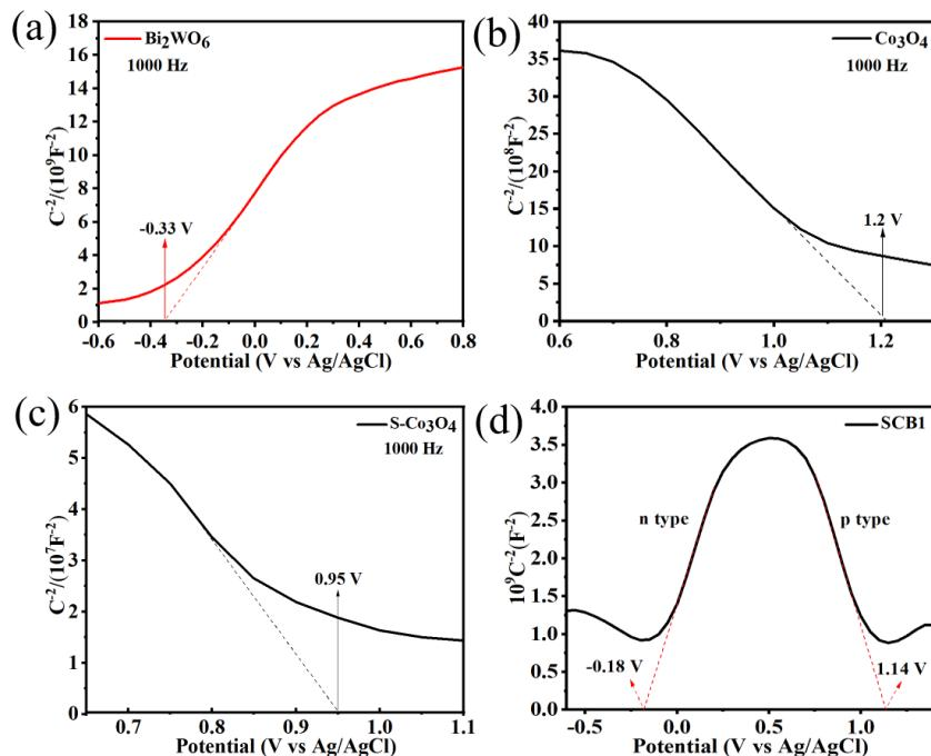
**Fig. S6** M-S curves for (a)  $\text{Bi}_2\text{WO}_6$ ; (b)  $\text{Co}_3\text{O}_4$ ; (c) S- $\text{Co}_3\text{O}_4$ ; and (d) SCB1.
