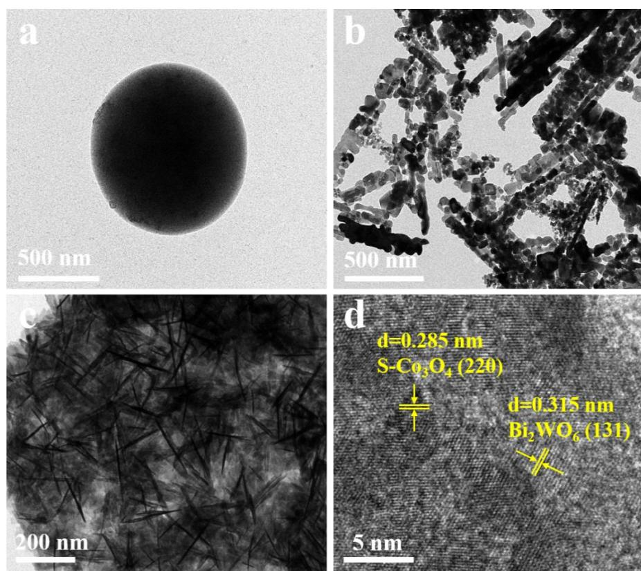
**Fig. S2** TEM images of the as-prepared samples: (a) pure  $\text{Co}_3\text{O}_4$ ; (b) S- $\text{Co}_3\text{O}_4$ ; and (c) pure  $\text{Bi}_2\text{WO}_6$ . (d) HRTEM image of the SCB1 composite.
