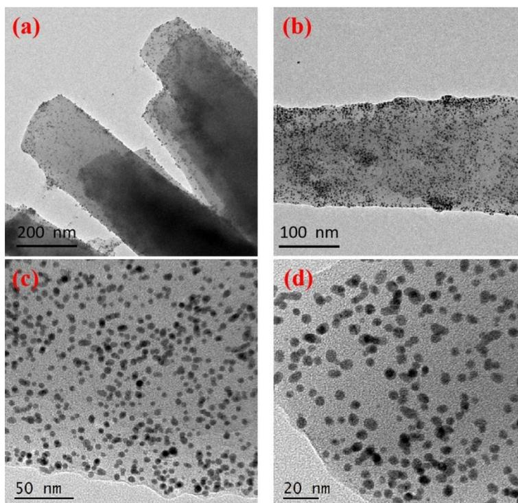
**Fig. S14** TEM images of 2-QY-Au NPs xerogel at different scales (a) 200 nm, (b) 100 nm, (c) 50 nm, (d) 20 nm.
