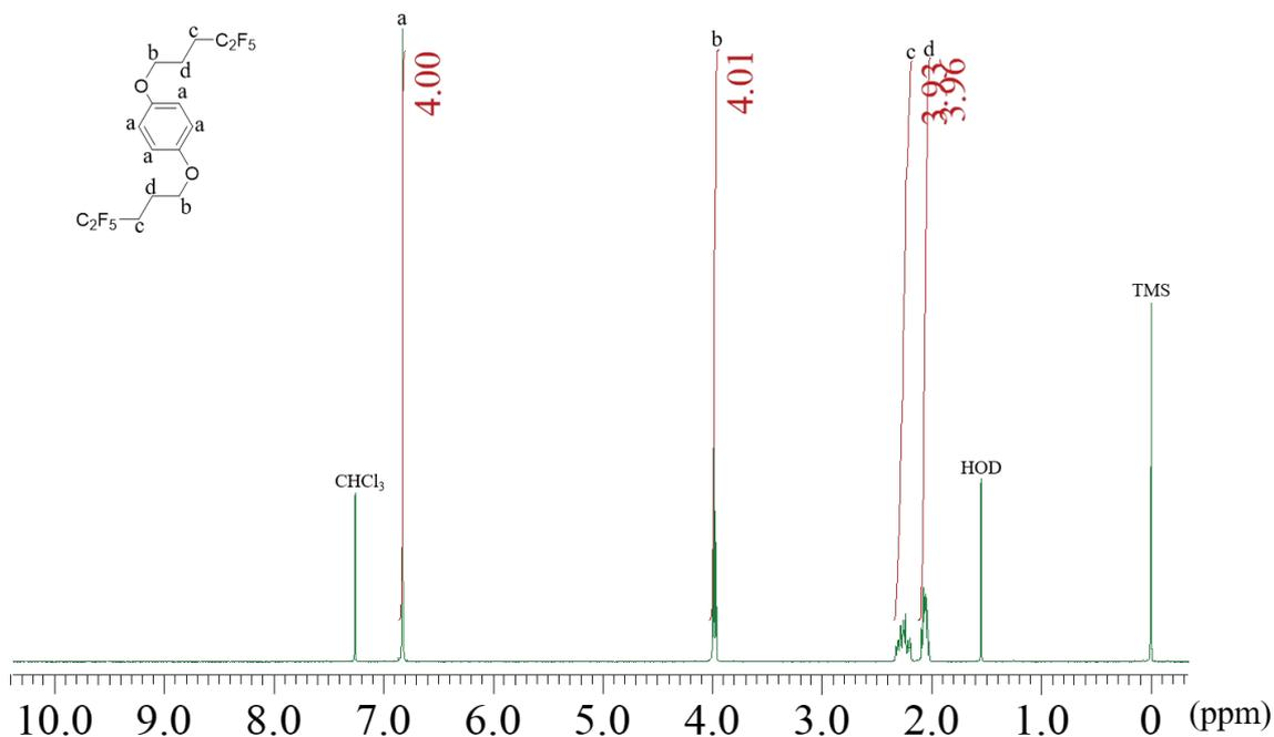
**Fig. S10**  $^1H$  NMR spectrum of **Monomer Unit** ( $CDCl_3$ , 25 °C).
