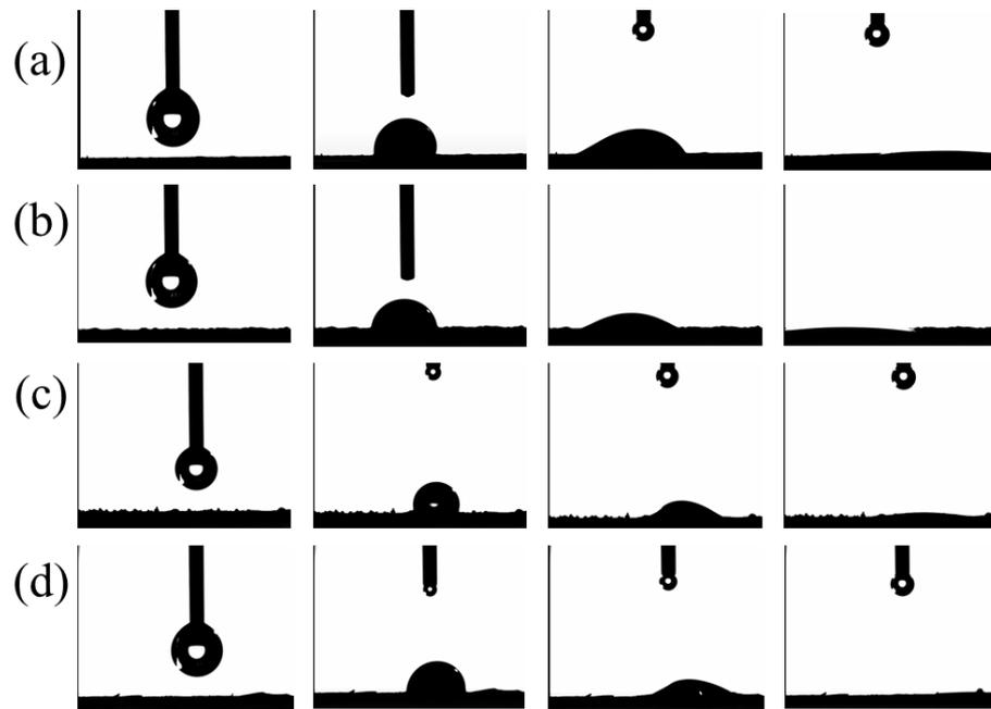
**Figure. S1** The Hydrophilicity of (a)CN, (b) CdS, (c) CS-65 and (d) CSR-3.
