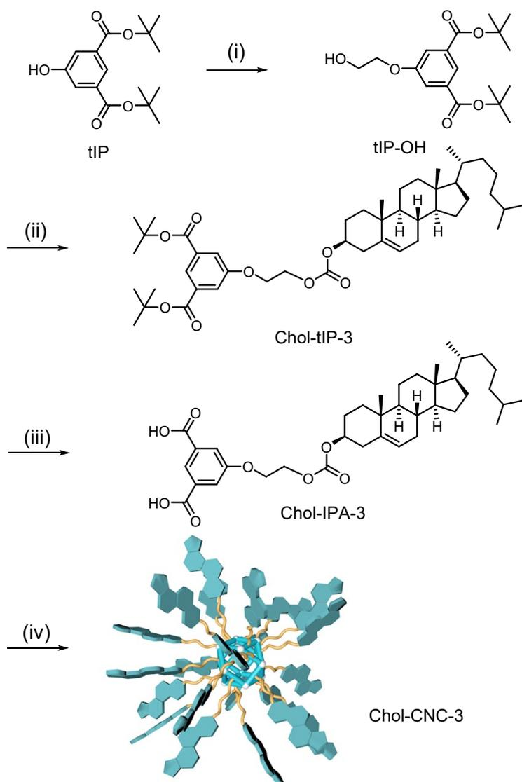
**Scheme S1.** Reaction conditions: (i) 2-bromoethanol,  $K_2CO_3$ , KI, acetone, 80 °C; (ii) Chol-Cl, DMAP, TEA,  $CH_2Cl_2$ , RT; (iii) TFA,  $CH_2Cl_2$ , RT; (iv)  $Cu(CH_3CO_2)_2 \cdot H_2O$ , DMF, THF, RT.
