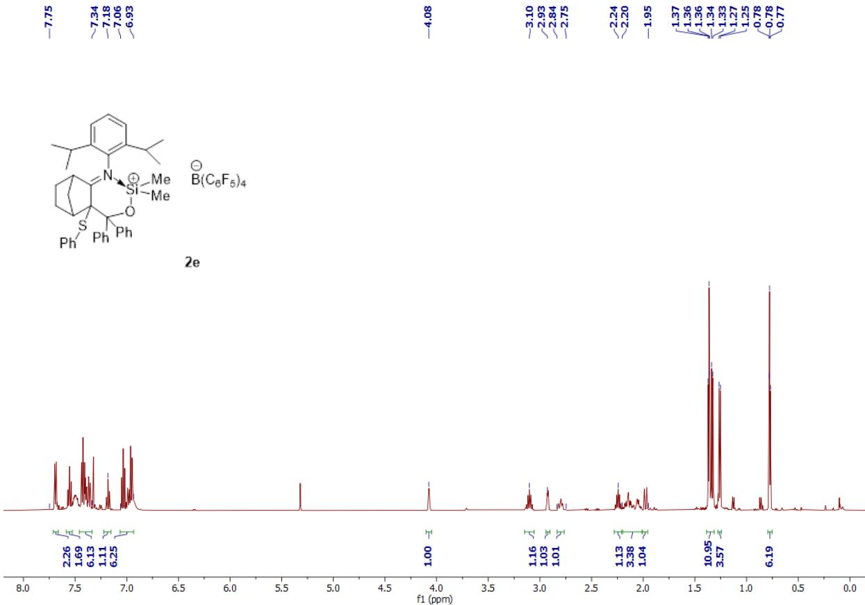
**Figure S22:**  $^1\text{H}$  NMR (500 MHz,  $\text{CD}_2\text{Cl}_2$ ) of **2e**
