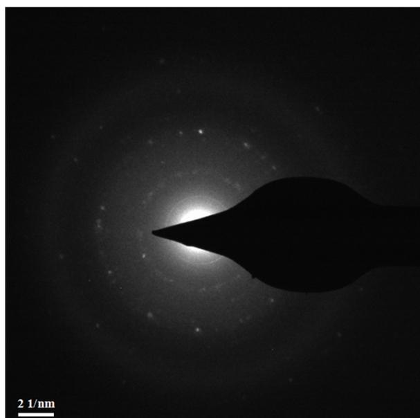
Fig. S2 The SAED patterns of Ni<sub>3</sub>S<sub>2</sub>/Co<sub>9</sub>S<sub>8</sub>/NiS-7.
