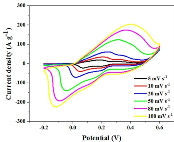
Fig. S6 CV curves of Ni<sub>3</sub>S<sub>2</sub>/Co<sub>9</sub>S<sub>8</sub>/NiS-9.
