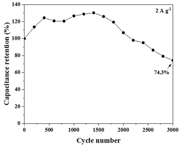
Fig. S14 Cycling stability of Ni<sub>3</sub>S<sub>2</sub>/Co<sub>9</sub>S<sub>8</sub>/NiS-9.
