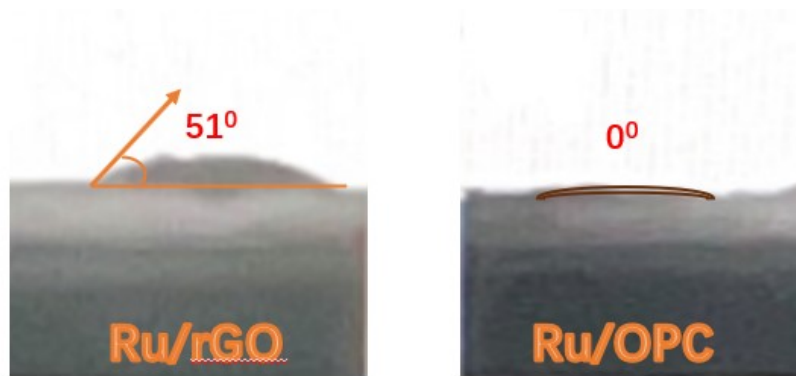
Fig. S10 Contact angle of Ru/rGO and Ru/OPC
