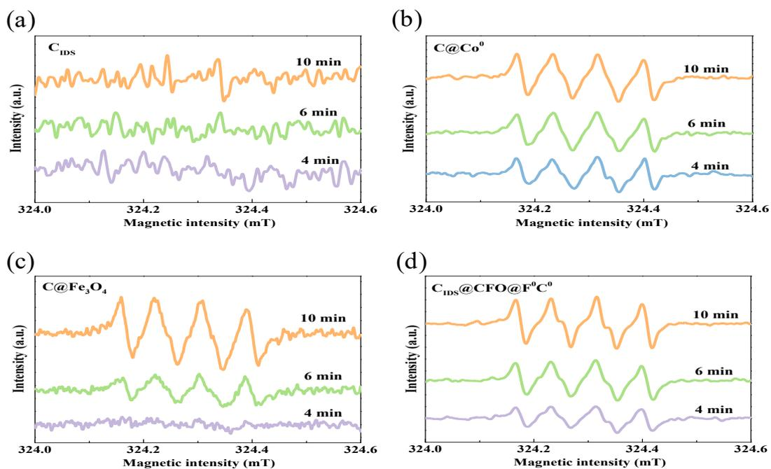
Fig. S10. EPR spectrum of  $\bullet\text{OH}$  in (a)  $\text{C}_{\text{IDS}}$ , (b)  $\text{C}@\text{Co}^0$ , (c)  $\text{C}@\text{Fe}_3\text{O}_4$  and (d)
