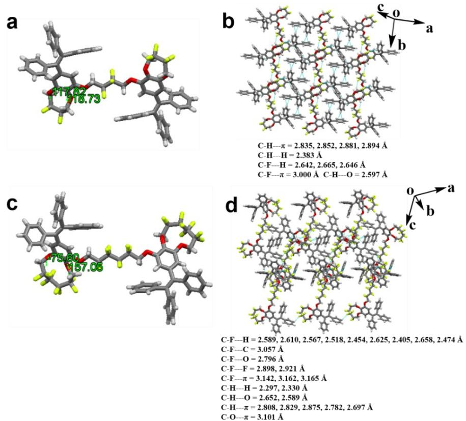
Fig. S23 Single crystal structure (a) 341F and (c) 381F and molecular packing of (b) 341F and (d) 381F.
