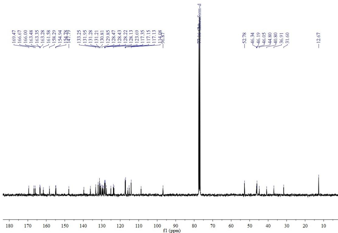
Figure S13.  $^{13}\text{C}$  NMR spectrum of CD-NA (chloroform-d).
