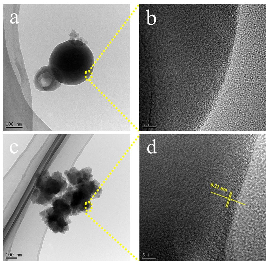
**Fig. S4** HRTEM images of a-b) AlHCF and c-d) AlHCF/Gr.
