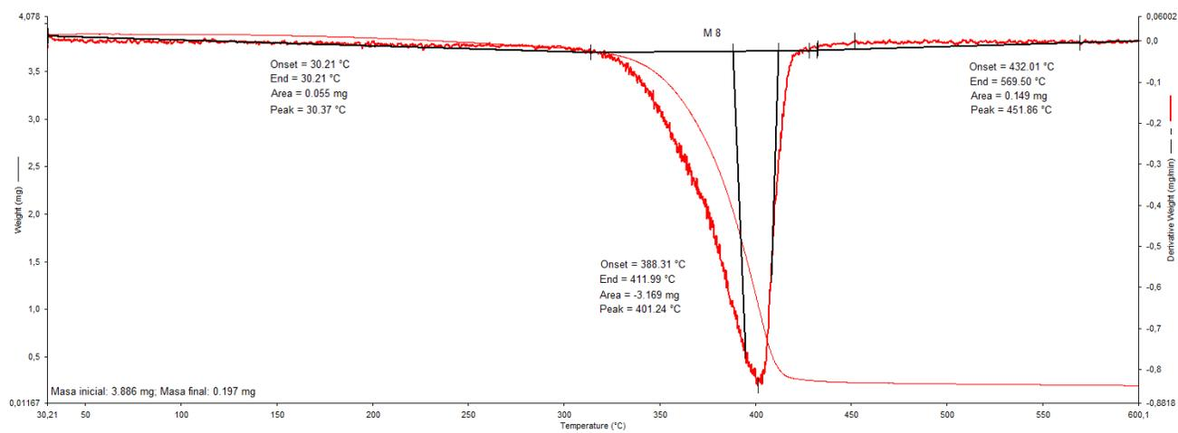
Figure S7: M6 - TGA thermogram.
