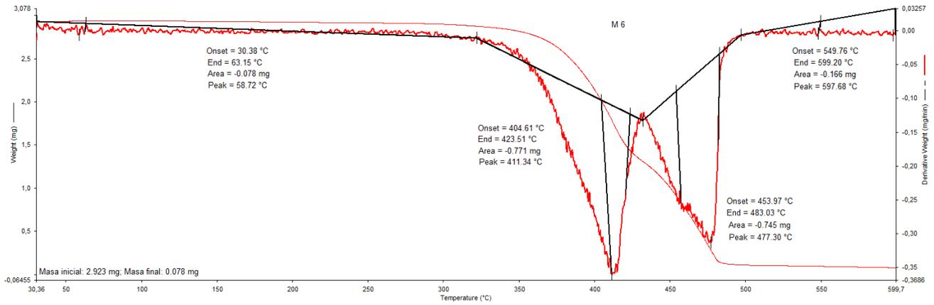
Figure S8: M15 - TGA thermogram.
