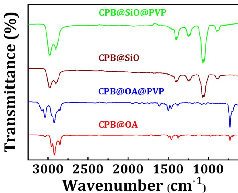
Figure S3: FTIR spectra of CPB@OA, CPB@OA@PVP, CPB@SiO, and (d) CPB@SiO@PVP NCs.
