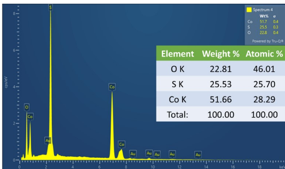
Fig. S9 EDX spectrum of \text{Co}_3\text{S}_4@\text{NF} .
