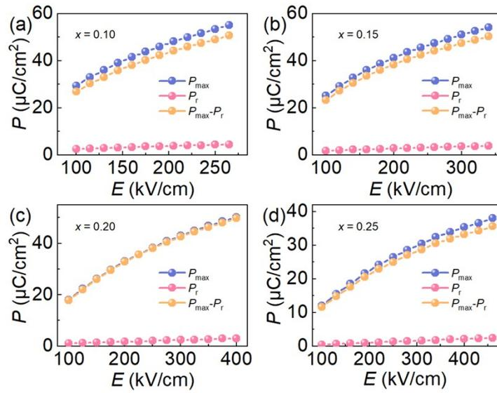
Fig. S5 Electric field dependent  $P_{\max}$ ,  $P_r$  and  $P_{\max}-P_r$  of (a)  $x = 0.10$ , (b)  $x = 0.15$ , (c)  $x = 0.20$ , (d)  $x = 0.25$ ,
