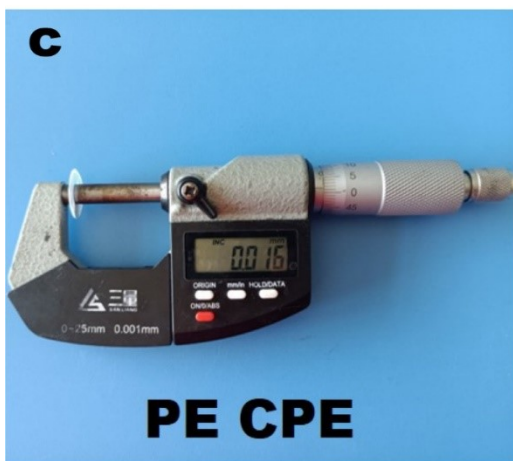
Fig. S7 The thickness of the a) PE separator and b) PE-PEG separator, c) PE CPE and d) PE-PEG CPE.
