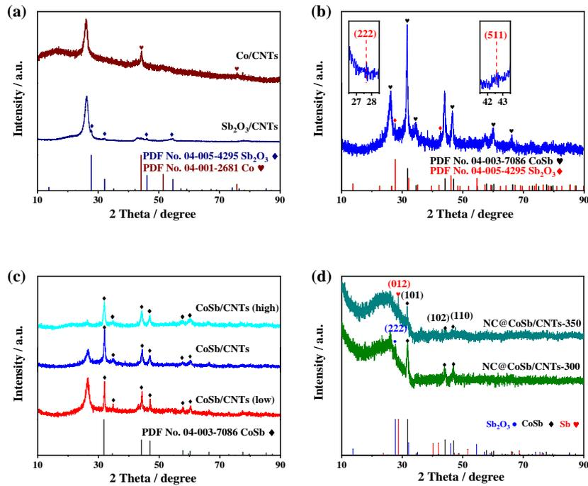
**Figure S5.** XRD patterns of (a)  $Sb_2O_3/CNTs$  and  $Co/CNTs$ , (b)  $CoSb/CNTs$ , (c)  $CoSb/CNTs$ ,  $CoSb/CNTs$ (high) and  $CoSb/CNTs$ (low), (d)  $NC@CoSb/CNTs-300$  and  $NC@CoSb/CNTs-350$ .
