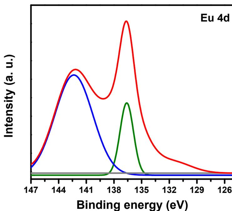
Fig. S1. XPS spectra of Eu 4d of the CNF/Eu<sub>2</sub>O<sub>3</sub>-1.
