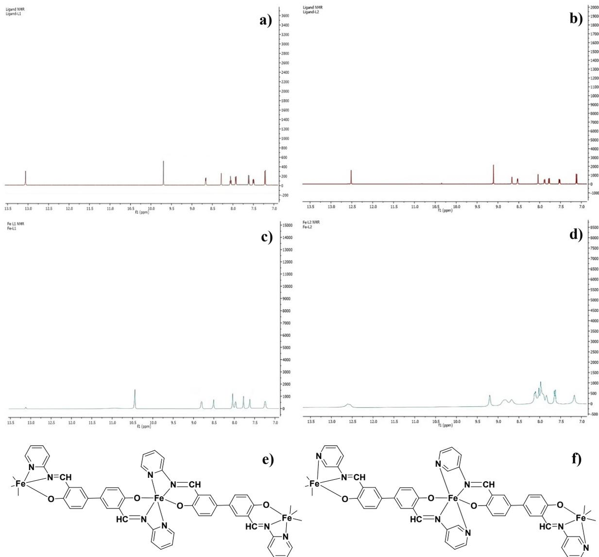
Figure .S-5.  $^1\text{H NMR}$  spectra of a) Ligand  $L_1$  b) Fe(II)- $L_1$  poly c) Ligand  $L_2$  and d) Fe(II)- $L_2$  poly and schematic coordination of e) Fe(II)- $L_1$  poly f) Fe(II)- $L_2$  poly
