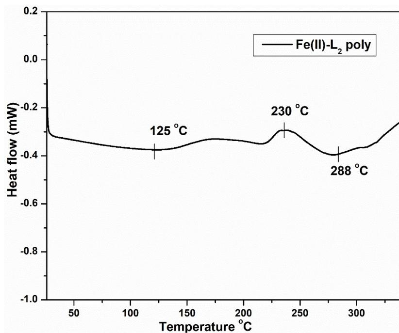
Figure .S-9. DSC Thermogram of Fe(II)-L<sub>2</sub> poly
