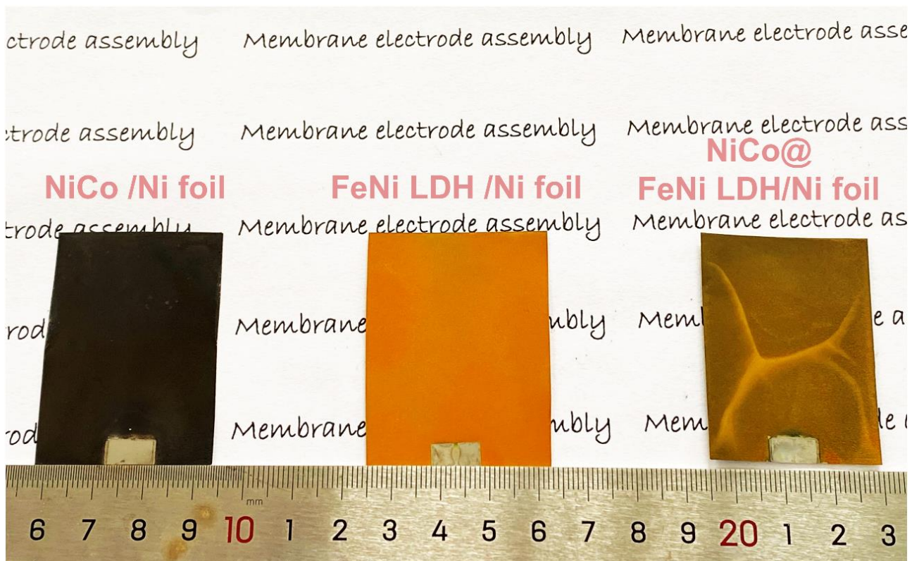
Fig. S11 | Digital images of NiCo LDH/Ni foil, NiCo 2 O 4 /Ni foil, NiCo 2 O 4 @FeNi LDH/Ni foil, NiCo/Ni foil, FeNi LDH/Ni foil and NiCo@FeNi LDH/Ni foil.
