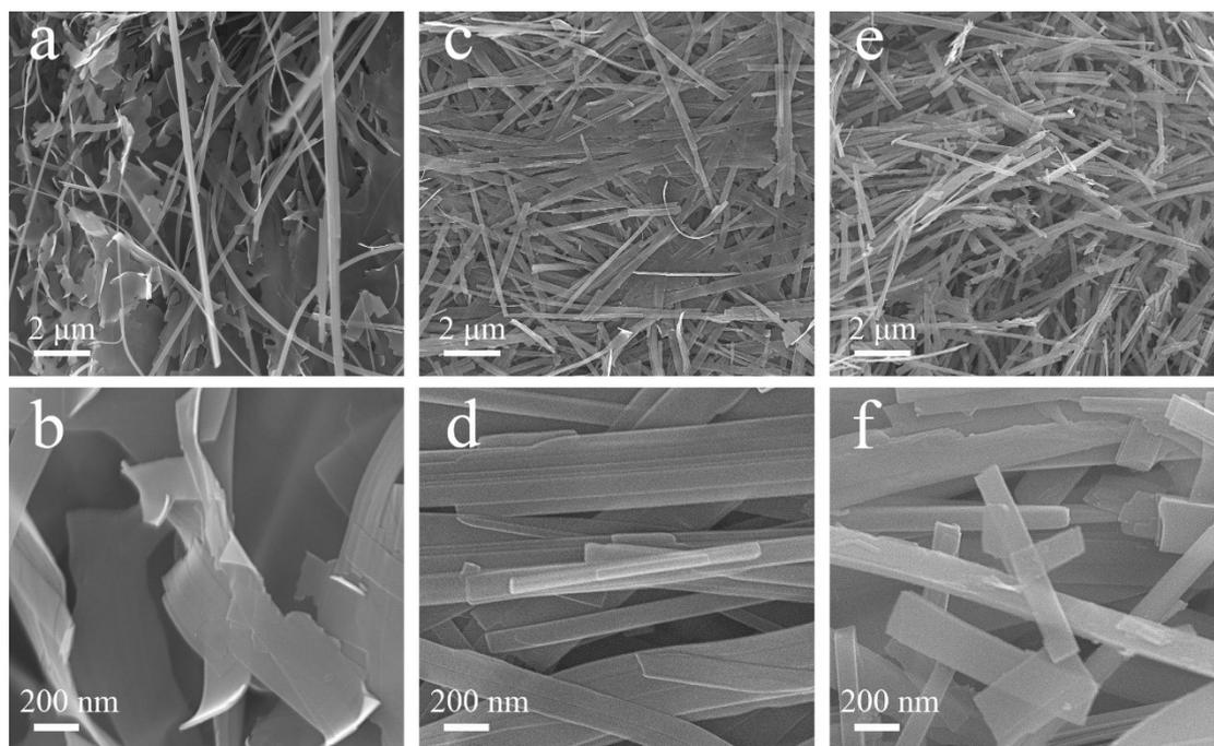
Fig. S3 SEM images of (a), (b) VO<sub>2</sub>(B)/V<sub>3</sub>O<sub>5</sub>, (c), (d) Fe<sub>0.05</sub>VO<sub>2</sub>(B)/V<sub>3</sub>O<sub>5</sub>, (e), (f) Fe<sub>0.15</sub>VO<sub>2</sub>(B)/V<sub>3</sub>O<sub>5</sub>
