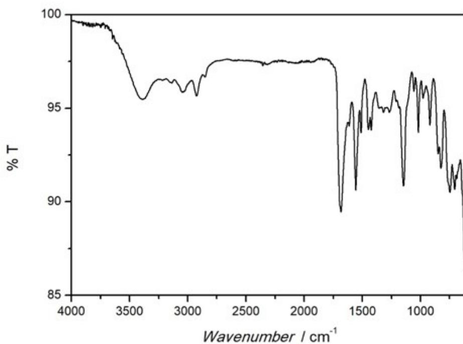
**Fig. S10** FT-ATR-IR spectra of TS-SILLP-4.
