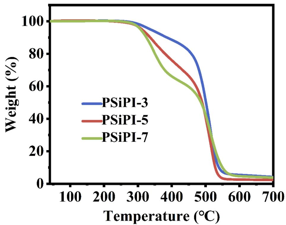
Fig. S7. Thermogravimetric curve of,PSiPI-3,5,7.
