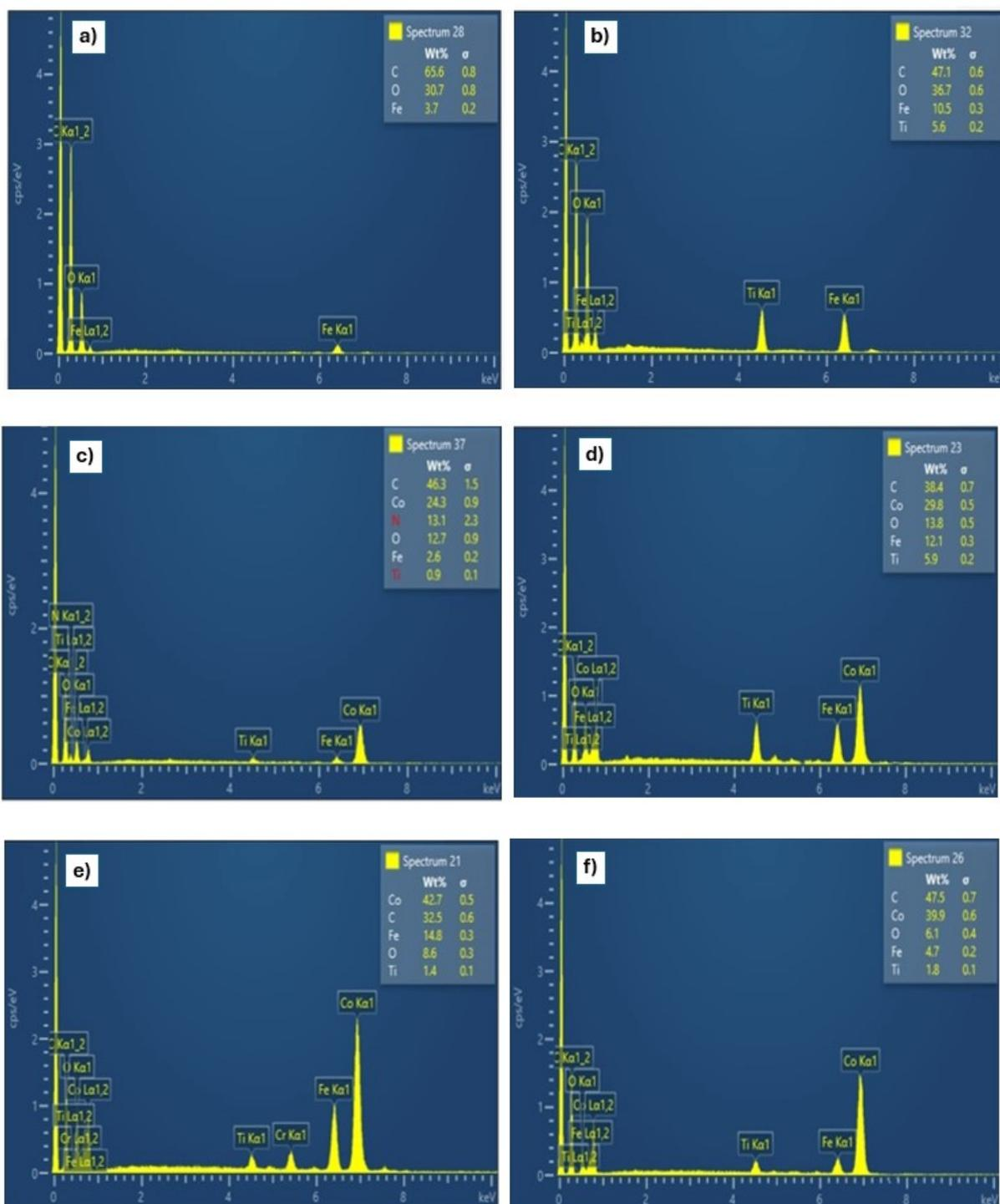
**Figure S2.** EDX element analysis of (a) Mil-53 (Fe), (b) MILMX, (c) MXMILZIF, (d) M1, (e) M2 and (f) M3.
