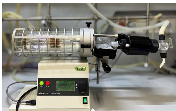
Fig. S15 Recycling Process (Kugelrohr distillation)
