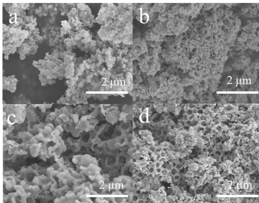
Fig. S1 SEM images of a) SnCu-1, b) SnCu-3, c) SnCuP/C-1, d) SnCuP/C-3.
