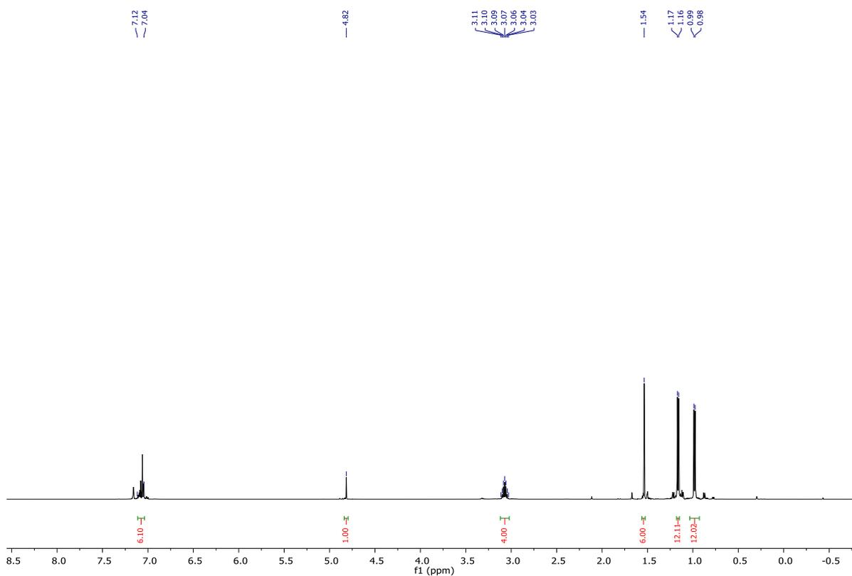
**Figure S24.**  $^1\text{H}$  NMR Spectrum ( $\text{C}_6\text{D}_6$ , 298 K, 500.06 MHz) for  $[(^{\text{Dipp}}\text{BDI})\text{Mg}]_2$ .
