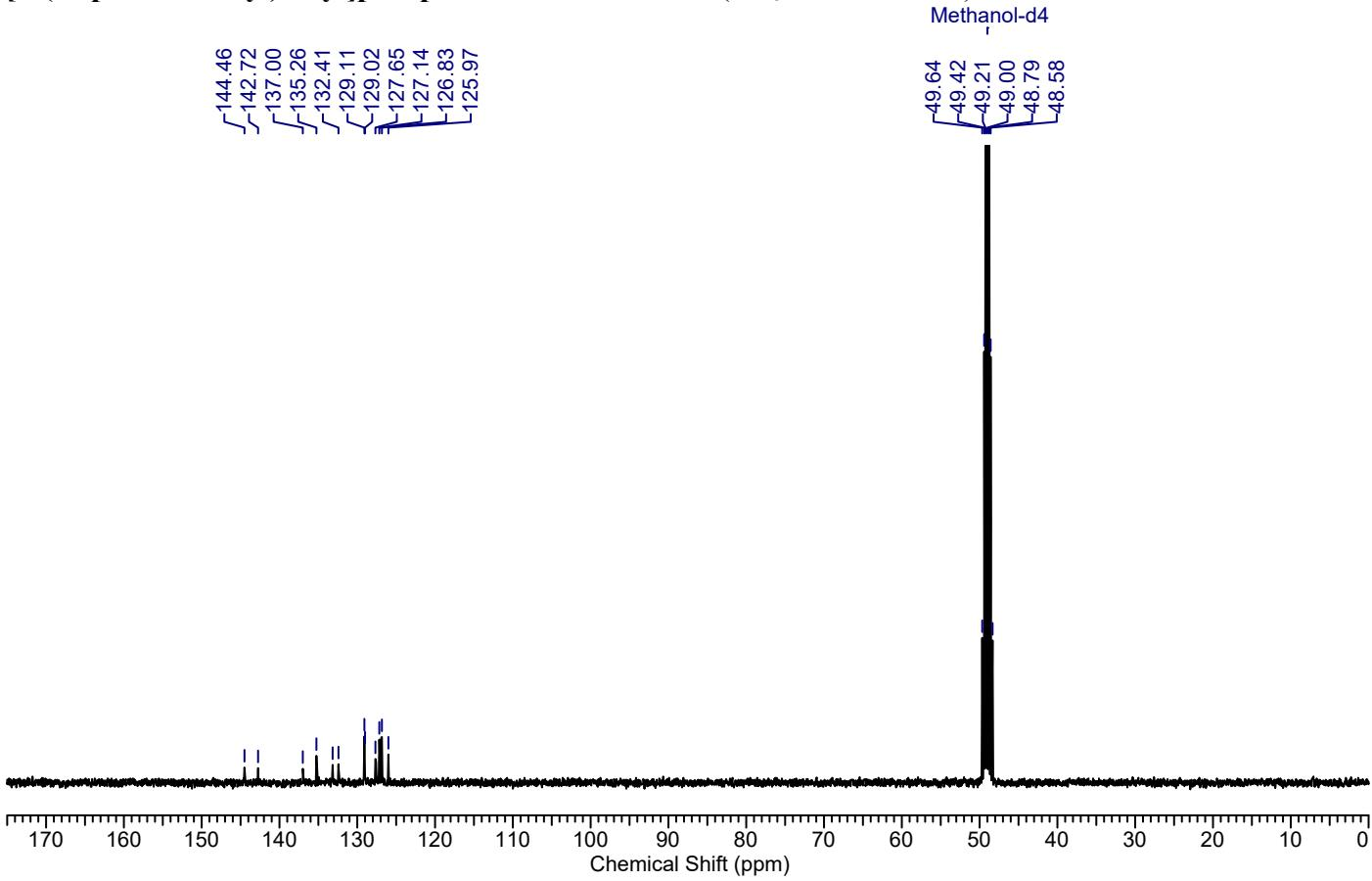
**(E)-(1-Phenylprop-1-en-1-yl)phosphonic acid:**  $^1\text{H}$  NMR (CD<sub>3</sub>OD, 400 MHz)
