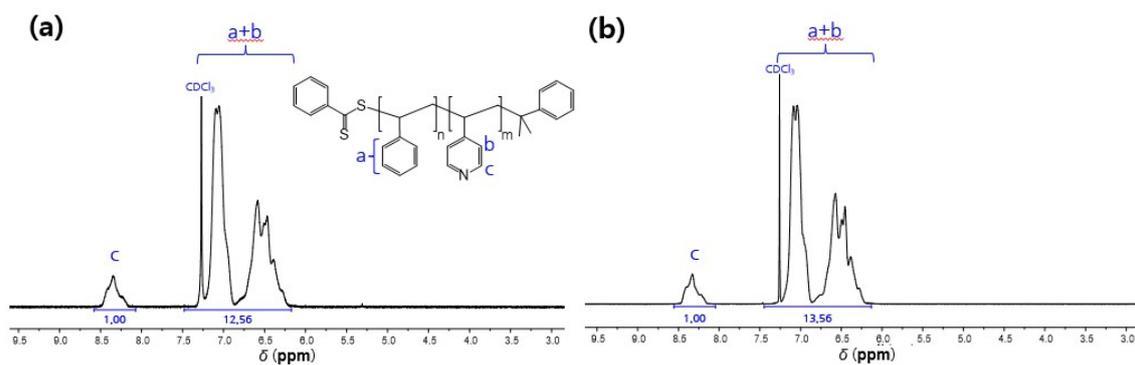
**Figure S7.** NMR spectra: (a) PS(266k)-*b*-P4VP(58k); (b) PS(80k)-*b*-P4VP(16k).
