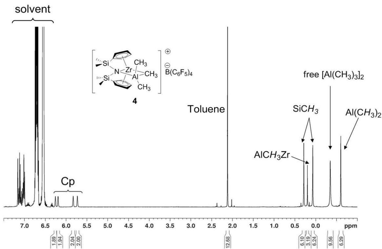
**Fig. S5**  $^1\text{H}$  NMR spectrum of **4** ((400 MHz,  $\text{C}_6\text{D}_6/1,2\text{-C}_6\text{H}_4\text{F}_2$ , 298 K).
