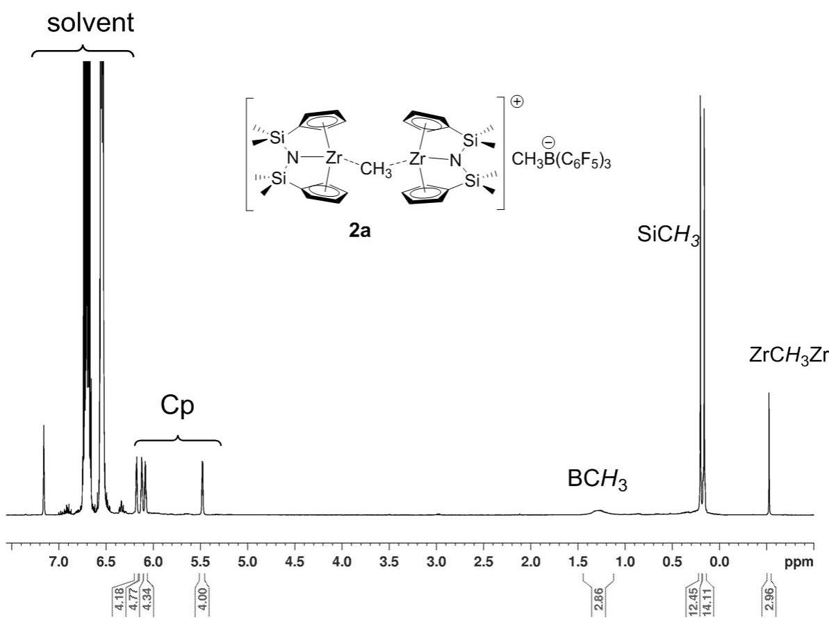
**Fig. S1**  $^1\text{H}$  NMR spectrum of **2a** (400 MHz,  $\text{C}_6\text{D}_6/1,2\text{-C}_6\text{H}_4\text{F}_2$ , 298 K).
