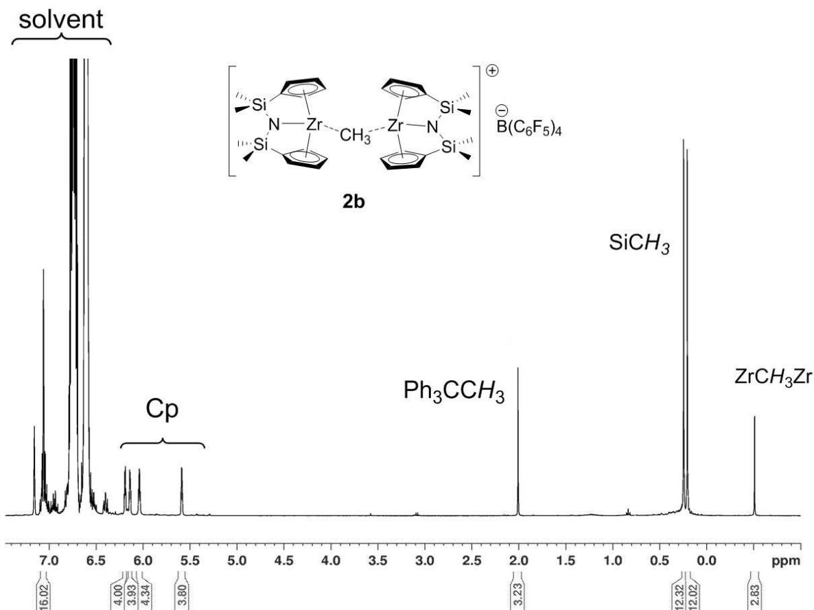
**Fig. S2**  $^1\text{H}$  NMR spectrum of **2b** (400 MHz,  $\text{C}_6\text{D}_6/1,2\text{-C}_6\text{H}_4\text{F}_2$ , 298 K).
