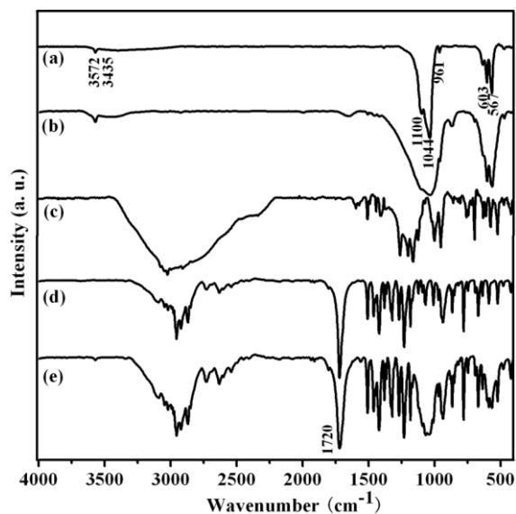
**Fig. S2** FT-IR spectra of (a) MHAp, (b) MHAp-FL, (c) PATPE, (d) IBU, (e) MHAp-FL-IBU.
