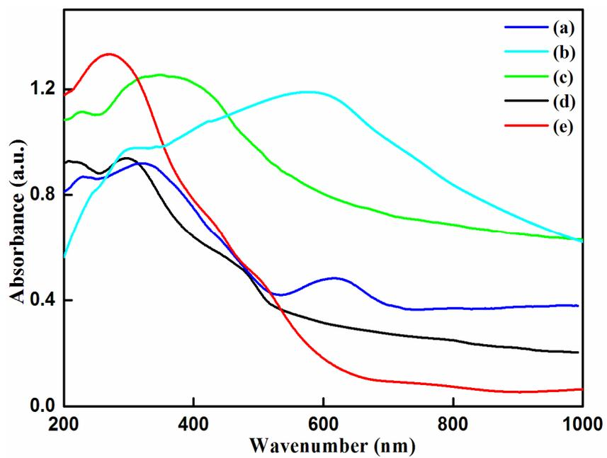
**Fig. S6** Diffuse reflectance spectra of  $\text{Ag}_3\text{LiMSbO}_6$  ( $M =$  (a) Cr, (b) Fe, (c) Mn, (d) Al, (e) Ga).
