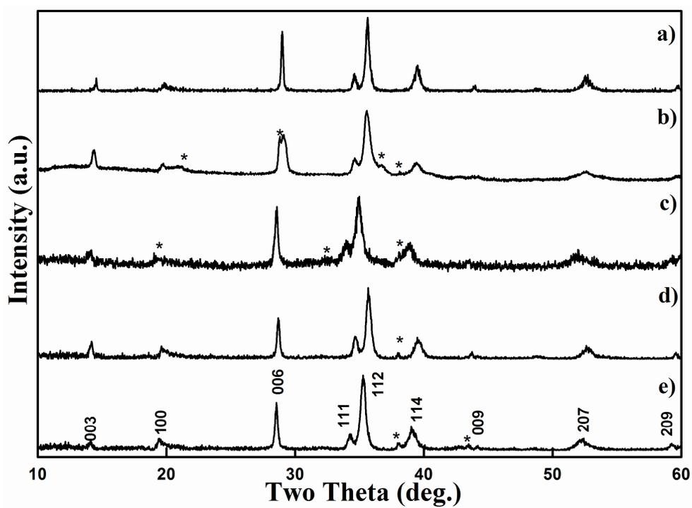
**Fig. S5** XRD patterns of  $\text{Ag}_3\text{LiMSbO}_6$  for  $M =$  (a) Cr, (b) Mn, (c) Fe, (d) Al, (e) Ga.
