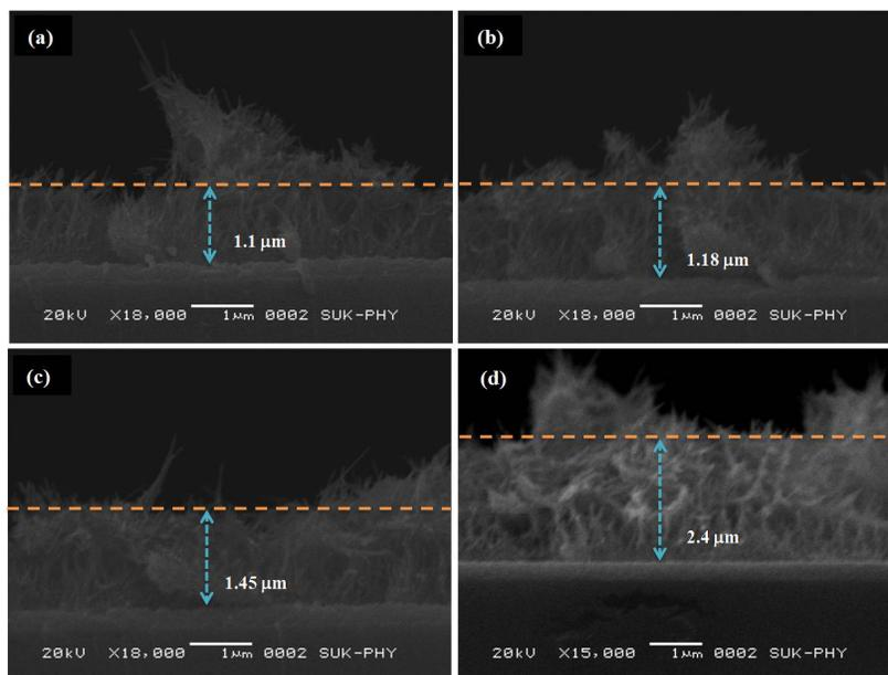
**Fig. S3** The cross section SEM images of  $\text{WO}_3$  thin film (a) sample  $\text{H}_4$ , (b)  $\text{H}_6$ , (c)  $\text{H}_8$  and (d)  $\text{H}_{10}$ .
