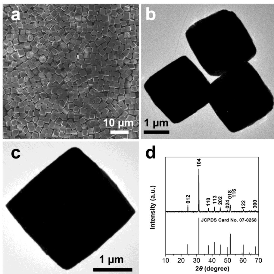
**Fig. S1** FESEM (a), TEM (b, c) images and XRD pattern (d) of  $\text{MnCO}_3$  microcubes.
