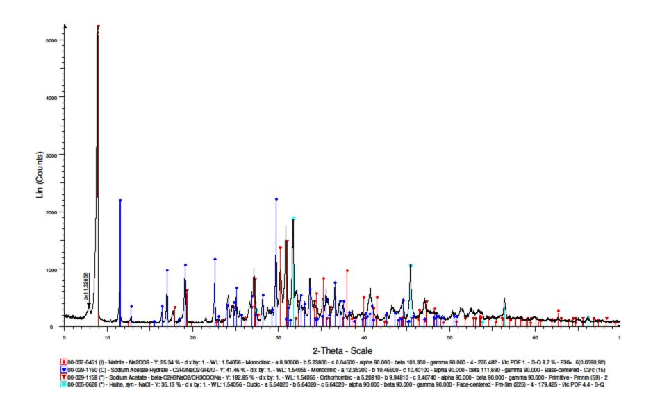
XRD SCAN OF DRIED AQUEOUS PHASE RESIDUE FROM COAL SHOWING THE PRESENCE OF SODIUM CARBONATE, SODIUM ACETATE AND SODIUM CHLORIDE
