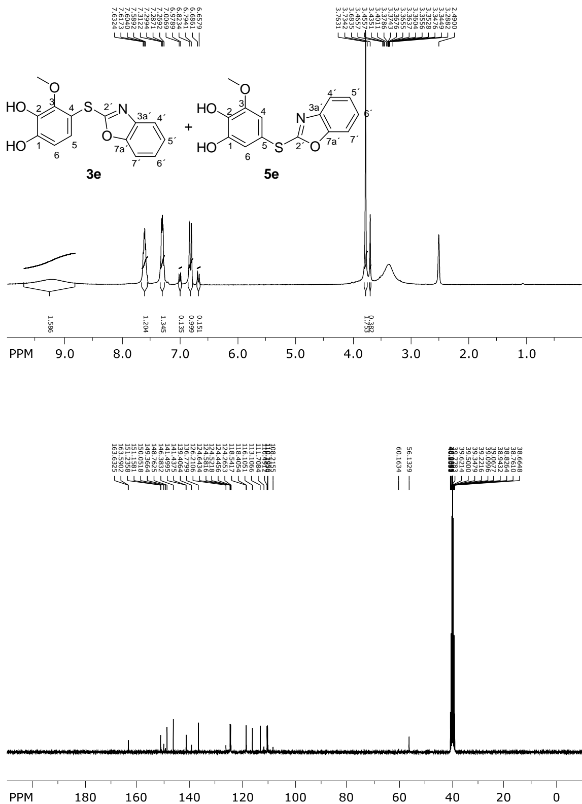
Fig. 5 1 H (300 MHz) and 13 C (75 MHz) NMR spectra of 3e and 5e in DMSO- d 6
