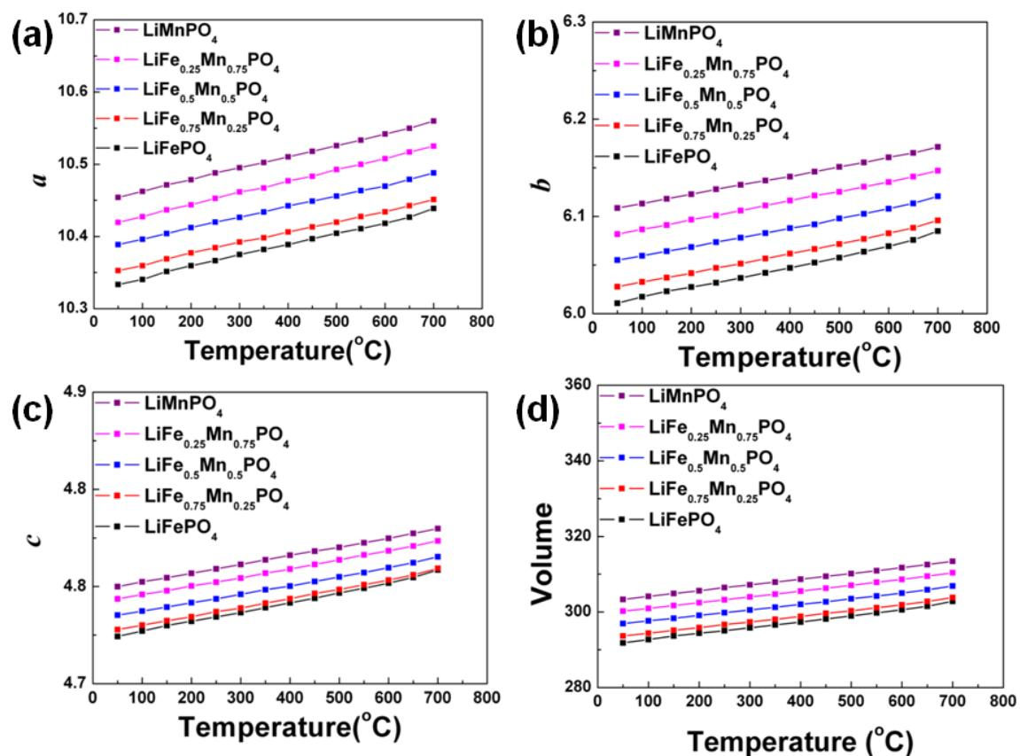
**Figure S3** (a) Lattice parameter  $a$ , (b) Lattice parameter  $b$ , (c) Lattice parameter  $c$ , and (d) volume of  $\text{LiFe}_{1-x}\text{Mn}_x\text{PO}_4$  [ $0 \leq x \leq 1$ ] varied by temperature.
