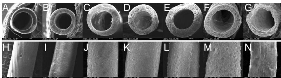
**Fig.S1** SEM images of microtubes of cellulose and cellulose/PEO. blends: (A, H) cellulose, (B, I)9:1 wt %, (C, J) 8:2 wt %, (D, K) 7:3 wt %, (E, L) 6:4 wt %, (F, M) 5:5 wt %, (G, N) 4:6 wt % (cellulose /PEO).
