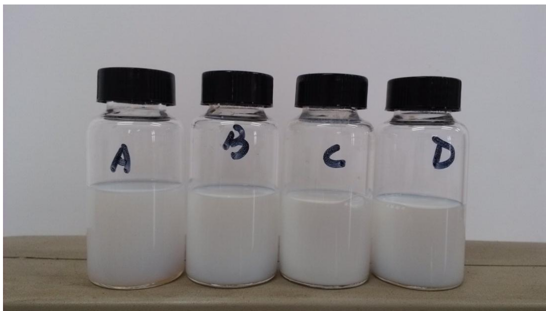
Fig. S1 The image of Poly(alkyltrialkoxysiloxane) Latex: (A) PTMS:MTES=1:1, (B) PTMS:MTES=4:1, (C) PTMS, (D) PTMS:OTMS=4:1
